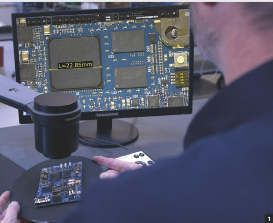
Fig. 1 – Il video microscopio Tagarno dispone di innumerevoli funzioni come il software di misura, che rende possibili rapporti precisi ed esaustivi
